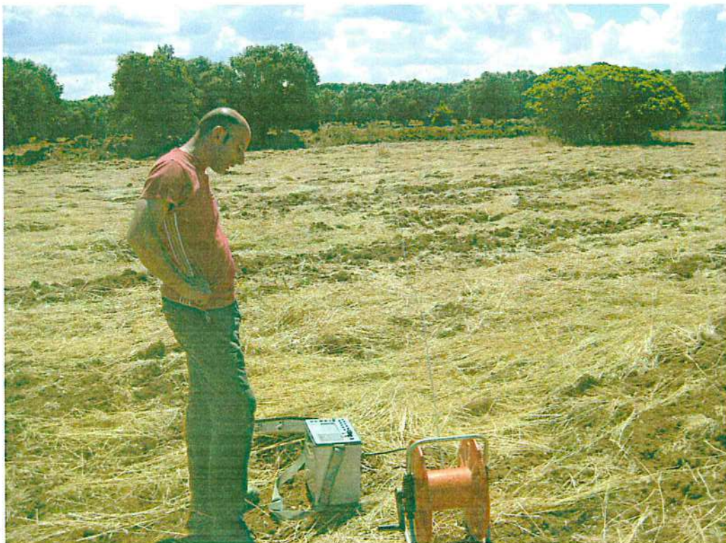
Esecuzione sondaggio elettrico n.3
