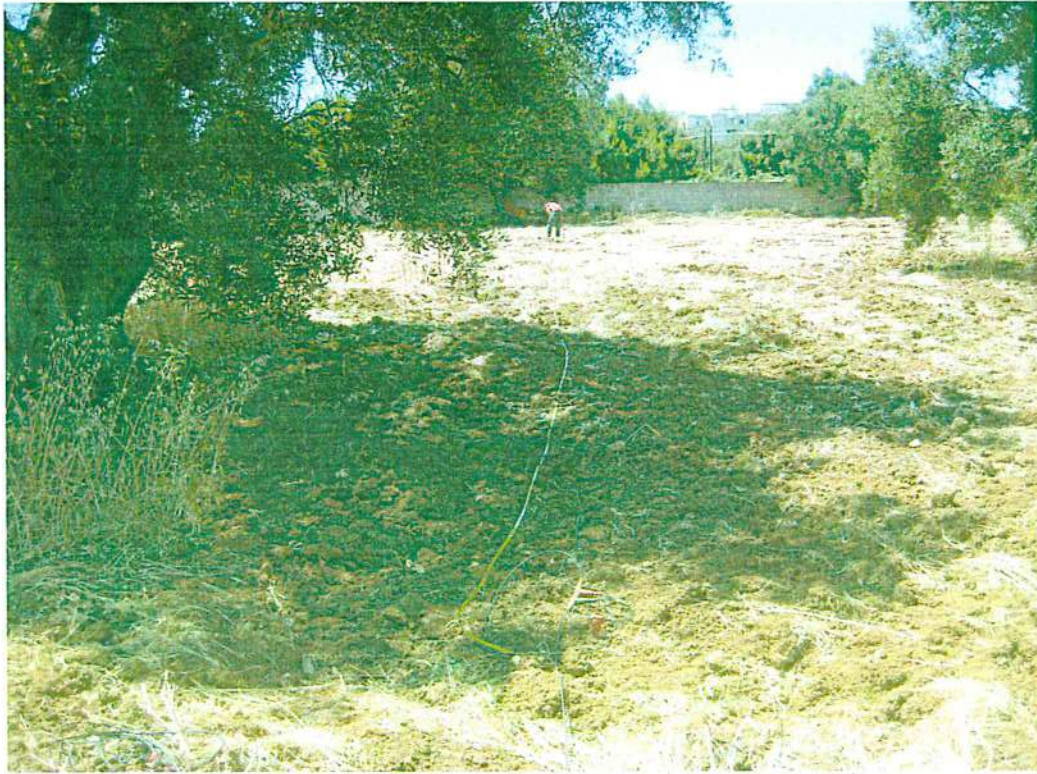
Esecuzione profilo sismico a rifrazione n.3 e ReMi sullo stesso stendimento
