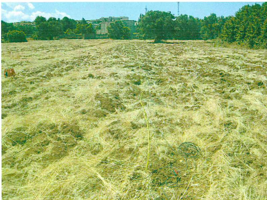
Esecuzione profilo sismico a rifrazione n.1 e ReMi sullo stesso stendimento
