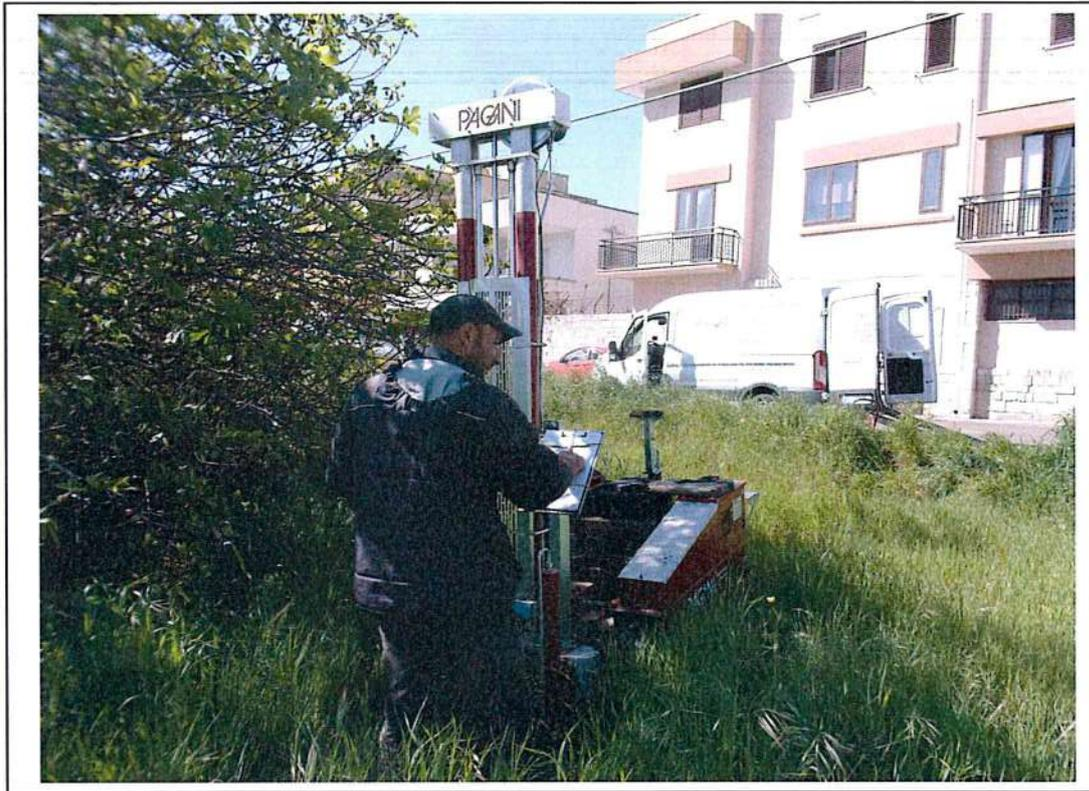
Esecuzione prova penetrometrica n. 1
