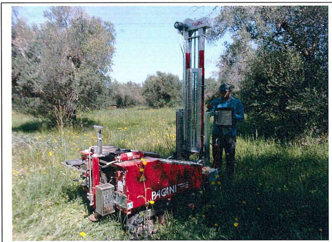
Esecuzione prova penetrometrica n. 5
