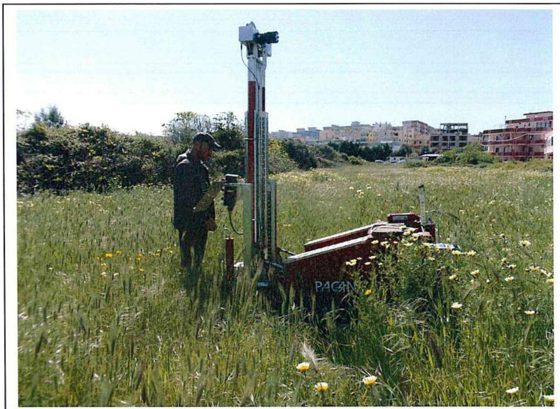
Esecuzione prova penetrometrica n. 2
