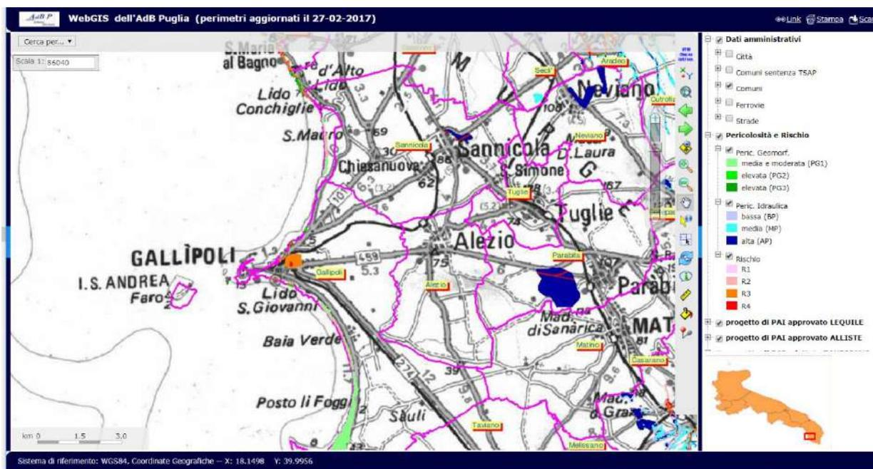
Figura 3-1 – Cartografia tematica del PAI relativa all’area oggetto di variante zoning per la progettazione preliminare della realizzazione del comparto R2b. Fonte: WebGIS dell’Autorità di Bacino con perimetri aggiornati al 27.02.2017.
