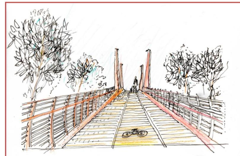
Il progetto della pista ciclabile si innesta sulla rotatoria prevista, quella in prossimità della Capitaneria di Porto (BluSalento), tramite un sovrappasso ciclo-pedonale per evitare le interferenze con la viabilità carraia. Il sovrappasso sarà costruito in acciaio con passerelle in legno e punti sosta a verde.
