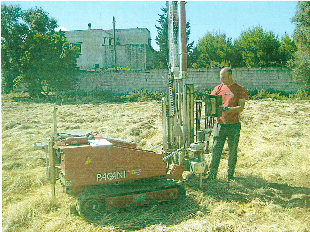
Esecuzione prova penetrometrica n.1
