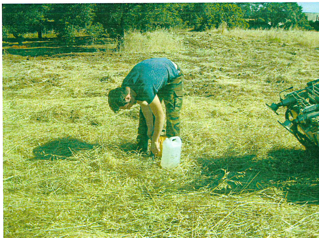
Esecuzione prova di permeabilità in foro n.2
