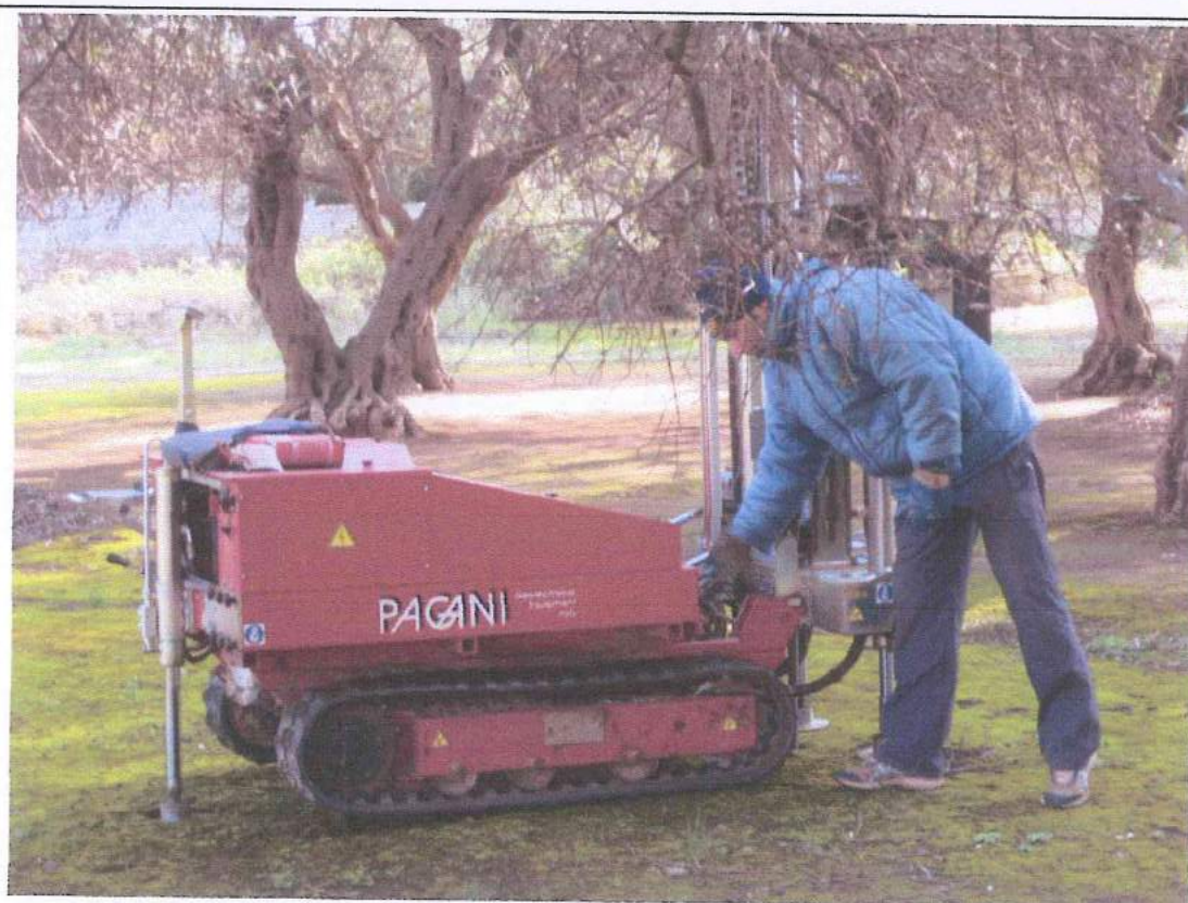
- Esecuzione prova penetrometrica n. 1
