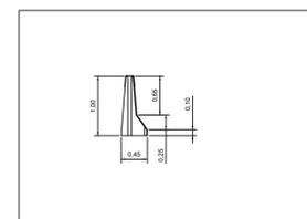
DETTAGLIO PROTEZIONE IN NEW-JERSEY - scala 1:50
