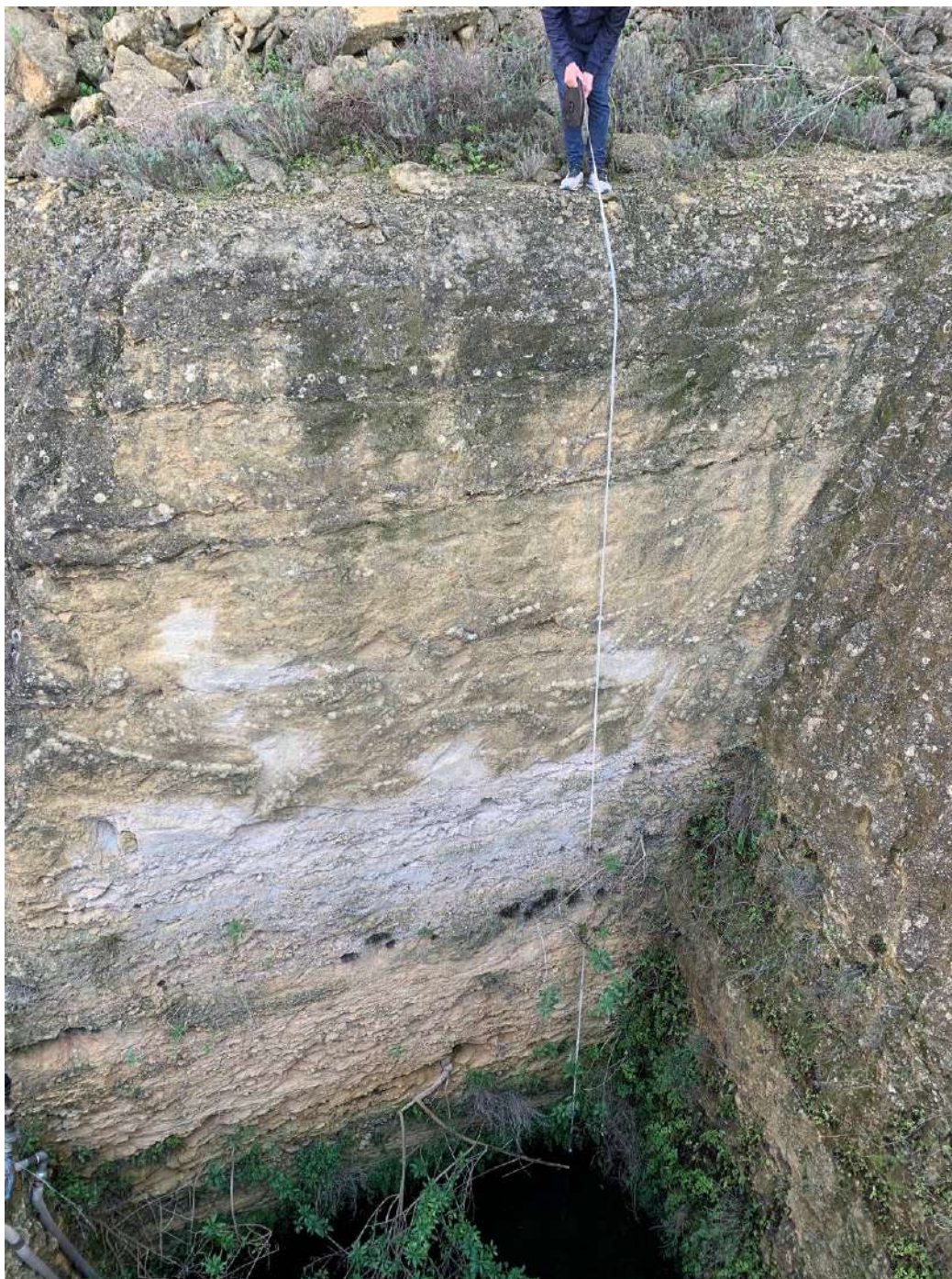
Foto 20 – Misurazione del livello freatico della falda superficiale all'interno del vecchio pozzo di scavo presente all'interno del Sito 2.
