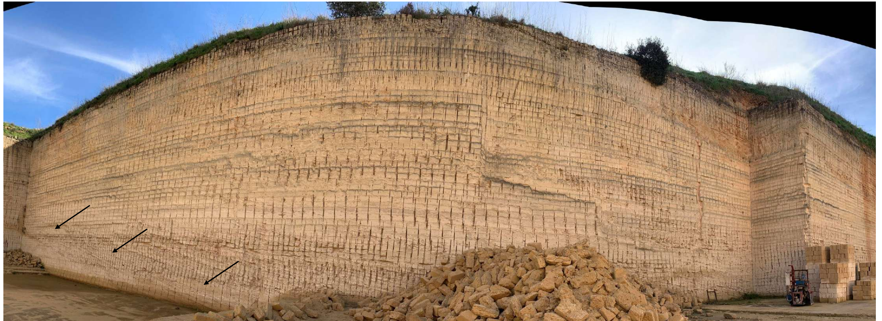
Foto 17 – La parete sud mostra sempre una successione calcarenitica con giacitura monoclinale immergente verso sud-ovest (N 220) con inclinazioni attorno a 18°-20°. Si presenta compatta.
