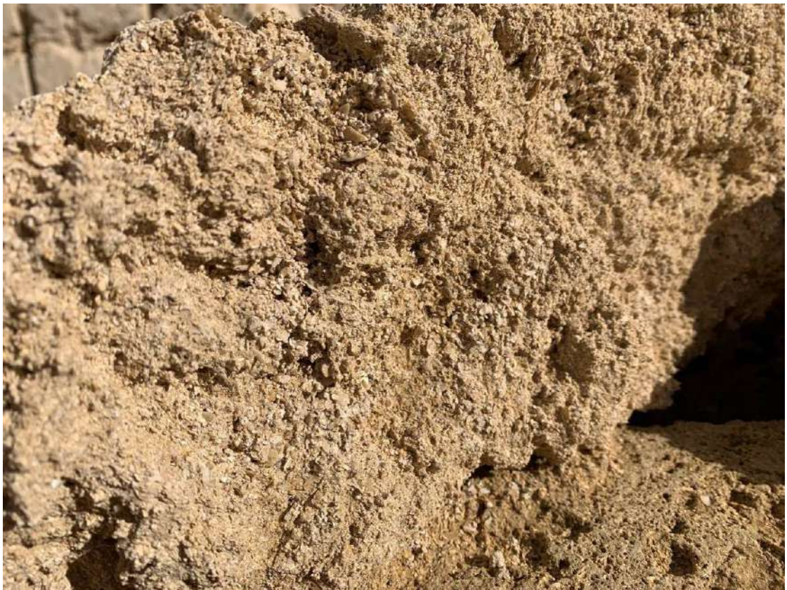
Foto 1,2 - I depositi calcarenitici quaternari affioranti nella cava in esame, conosciuti col nome di "carparo", sono rappresentati da calcareniti grossolane, ben cementate, porose, di colore giallo-ocraceo.
