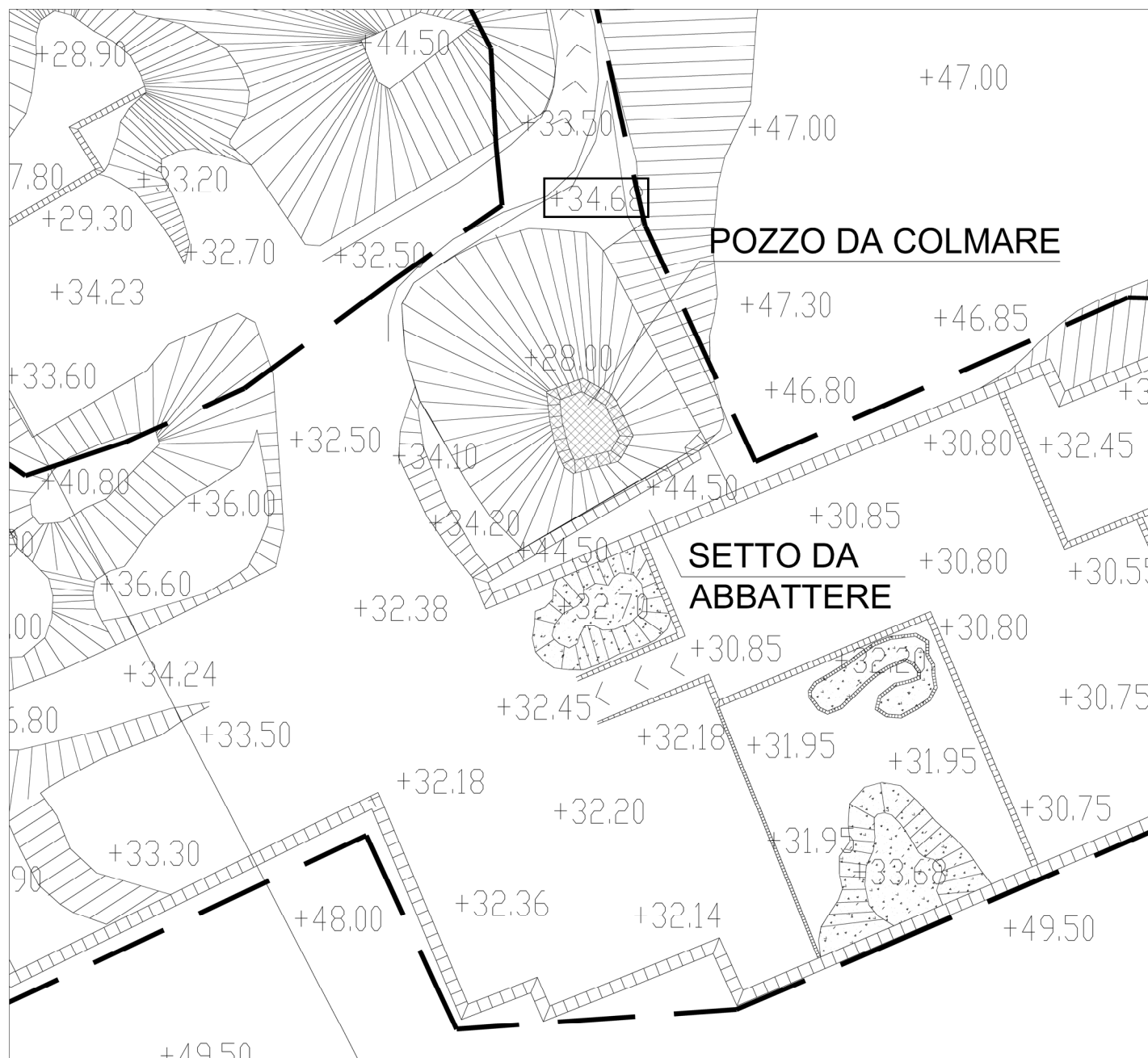
Fig. 9 - Ubicazione del pozzo di scavo, attestato nella falda superficiale, presente all'interno dell'Area 1.
