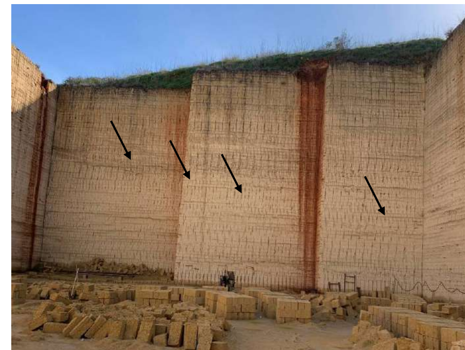
Foto 10, 11 - Anche sulle pareti di sud-est (Foto 10) e sud (Foto 11) si legge la medesima giacitura monoclinale e sono assolutamente prive di qualsiasi giunto di fratturazione.
