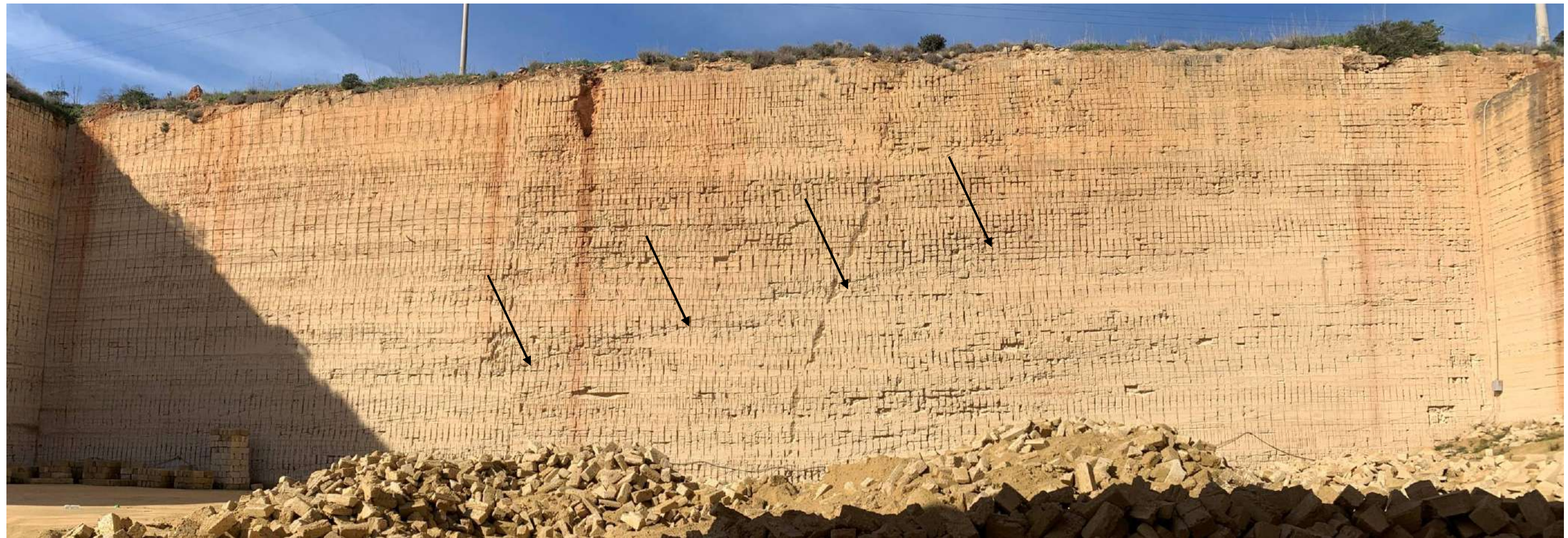
Foto 9 – La parete nord-ovest mostra una successione calcarenitica con giacitura monoclinale immergente verso sud-ovest (N 220) con inclinazioni attorno a 18°-20°. Si presenta compatta e assolutamente priva di giunti di fratturazione.
