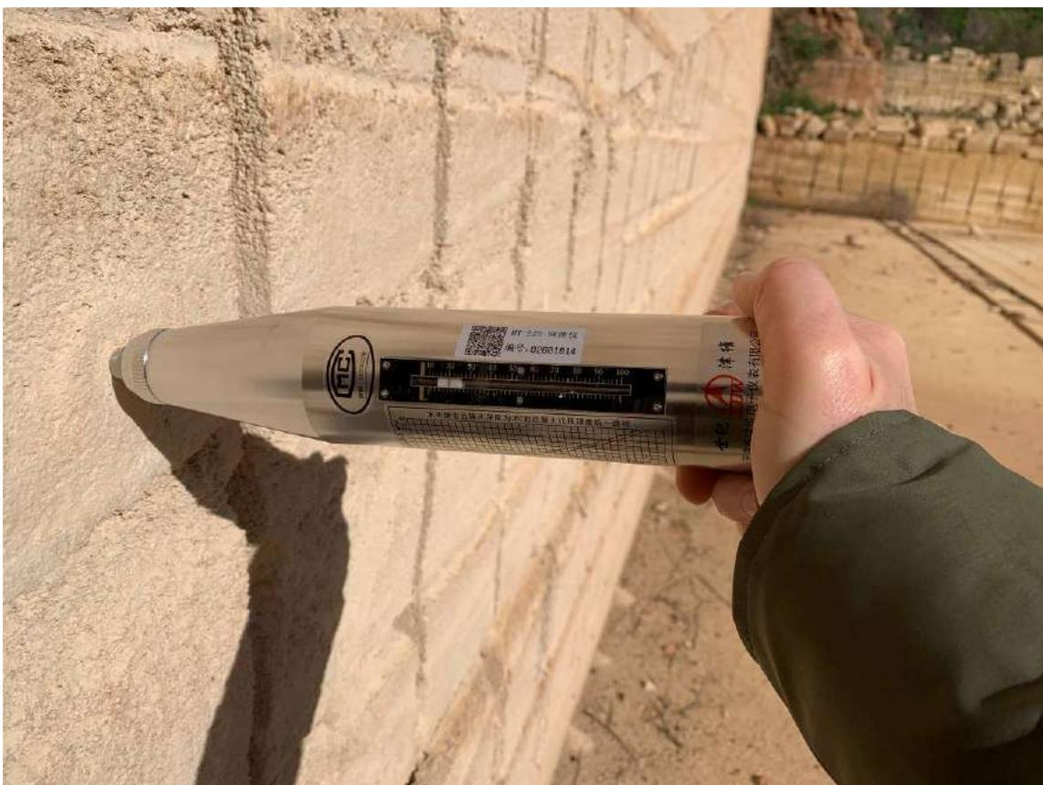
*Foto 26 – Esecuzione delle misure sclerometriche sui fronti del settore orientale.*
