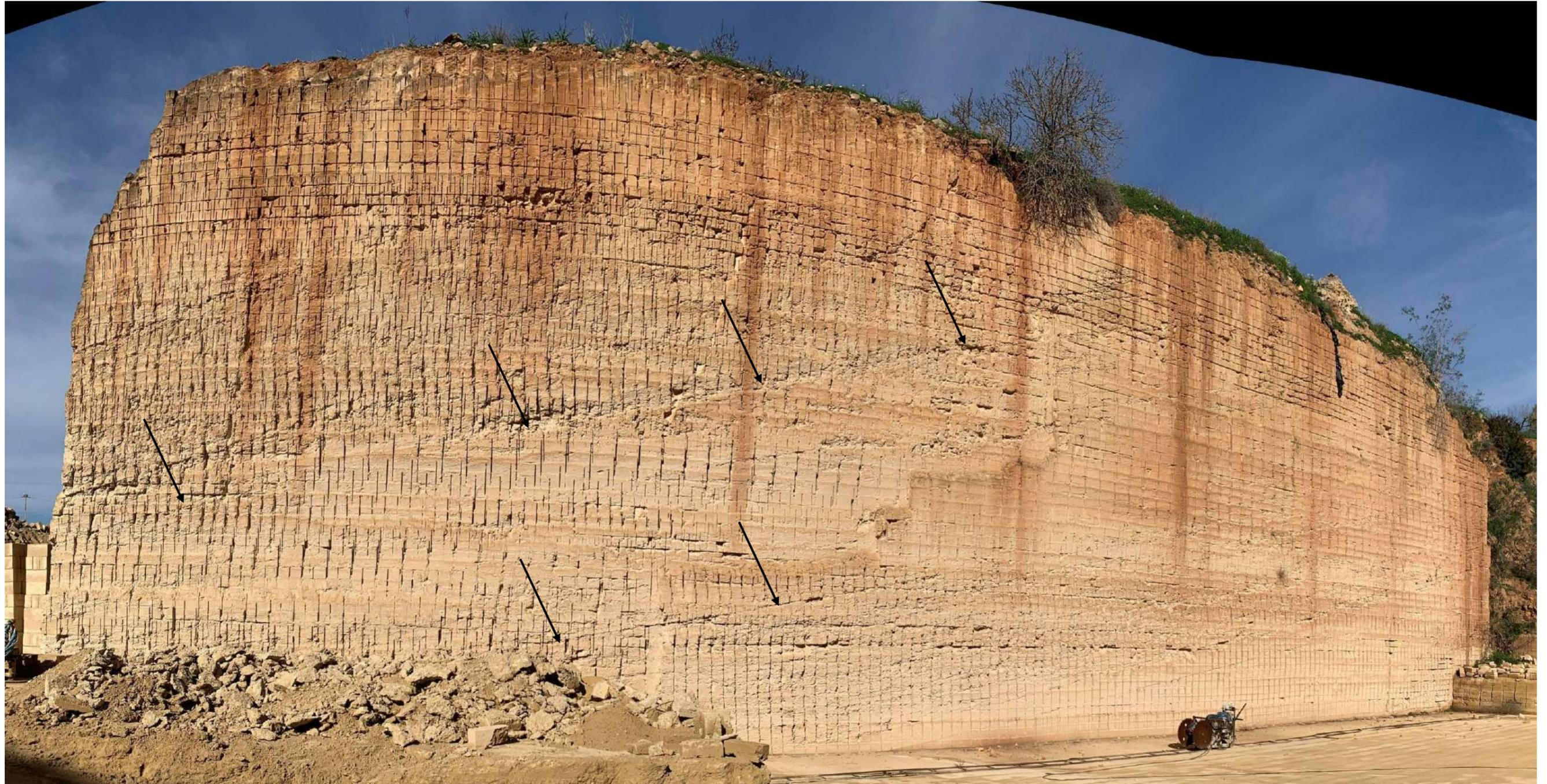
*Foto 14 – La parete nord mostra sempre una successione calcarenitica con giacitura monoclinale immergente verso sud-ovest (N 220) con inclinazioni attorno a 18°-20°. Si presenta compatta e assolutamente priva di giunti di fratturazione.*
