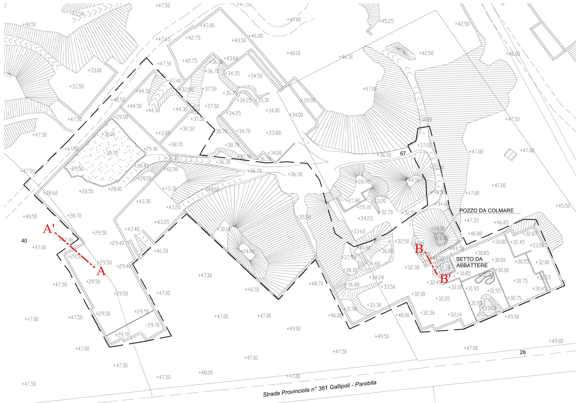
Fig. 4.2 - Ubicazione delle sezioni di verifica dei fronti di cava.
