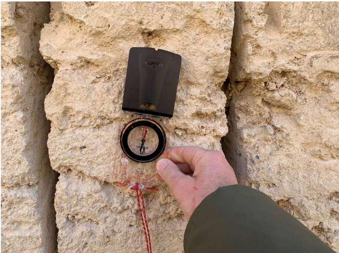
*Foto 20,21 – Rilievo delle giaciture dei piani di stratificazione.*
