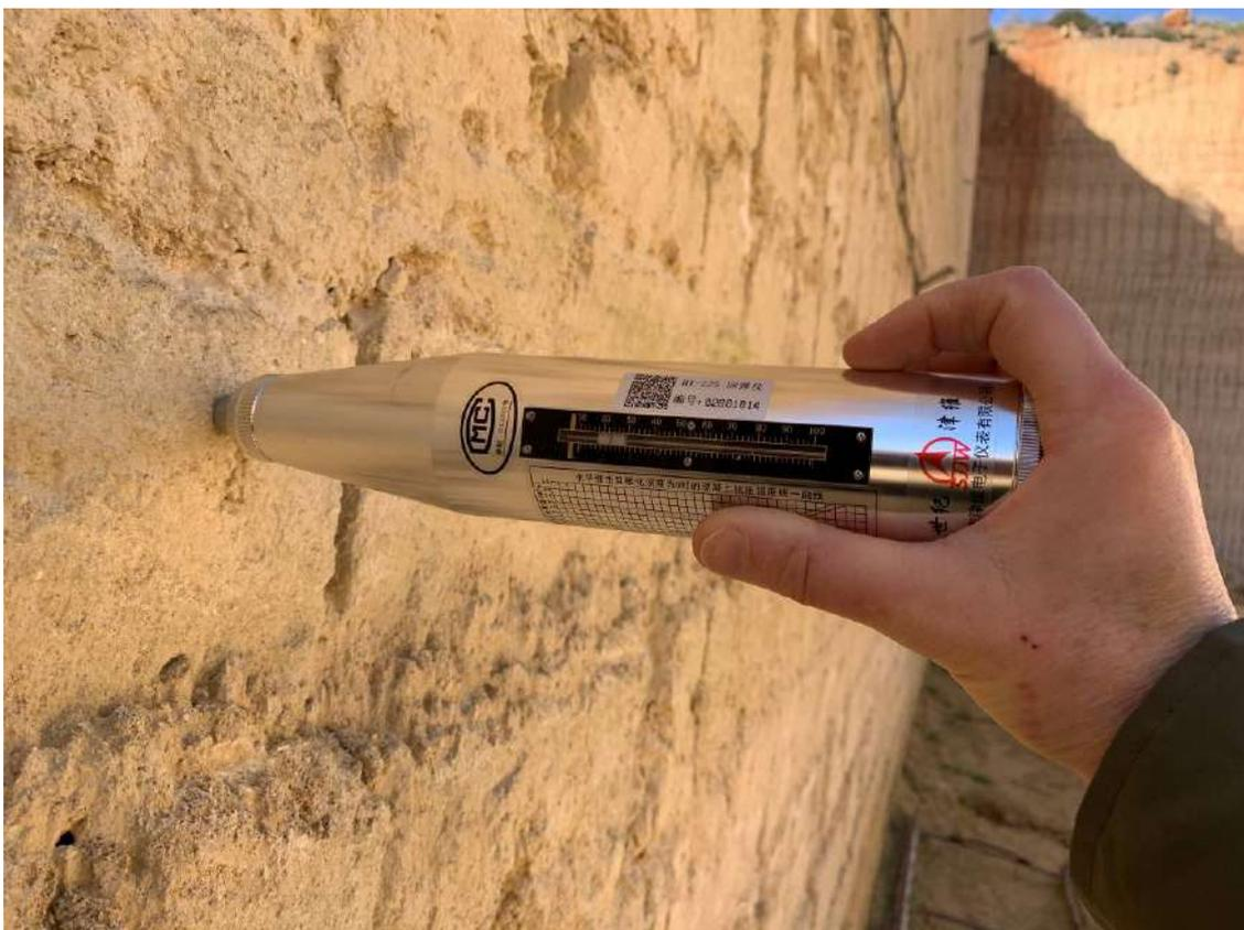
*Foto 25 – Esecuzione delle misure sclerometriche sui fronti del settore occidentale.*
